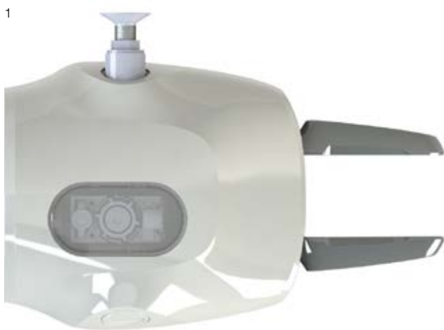
1. Ręka z serwonapędem i przyssawka pneumatyczna, z kamerą | 2. Ręka z serwonapędem i dwie przyssawki pneumatyczne ze wskaźnikami statusu
